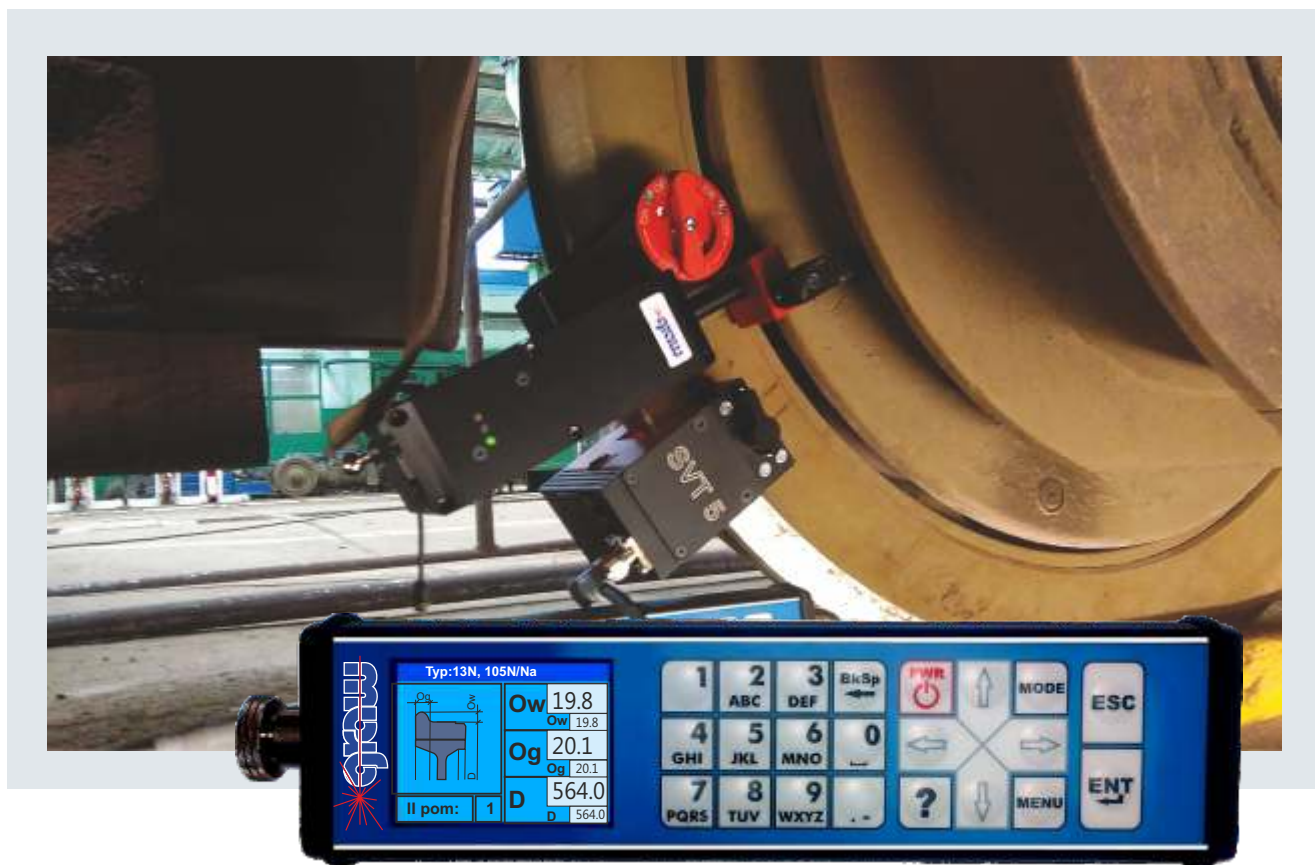
Pulpit urządzenia z widocznym oknem pomiarowym
